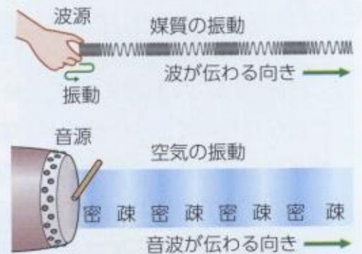
▲図1 ばねを伝わる縦波と音波の比較
