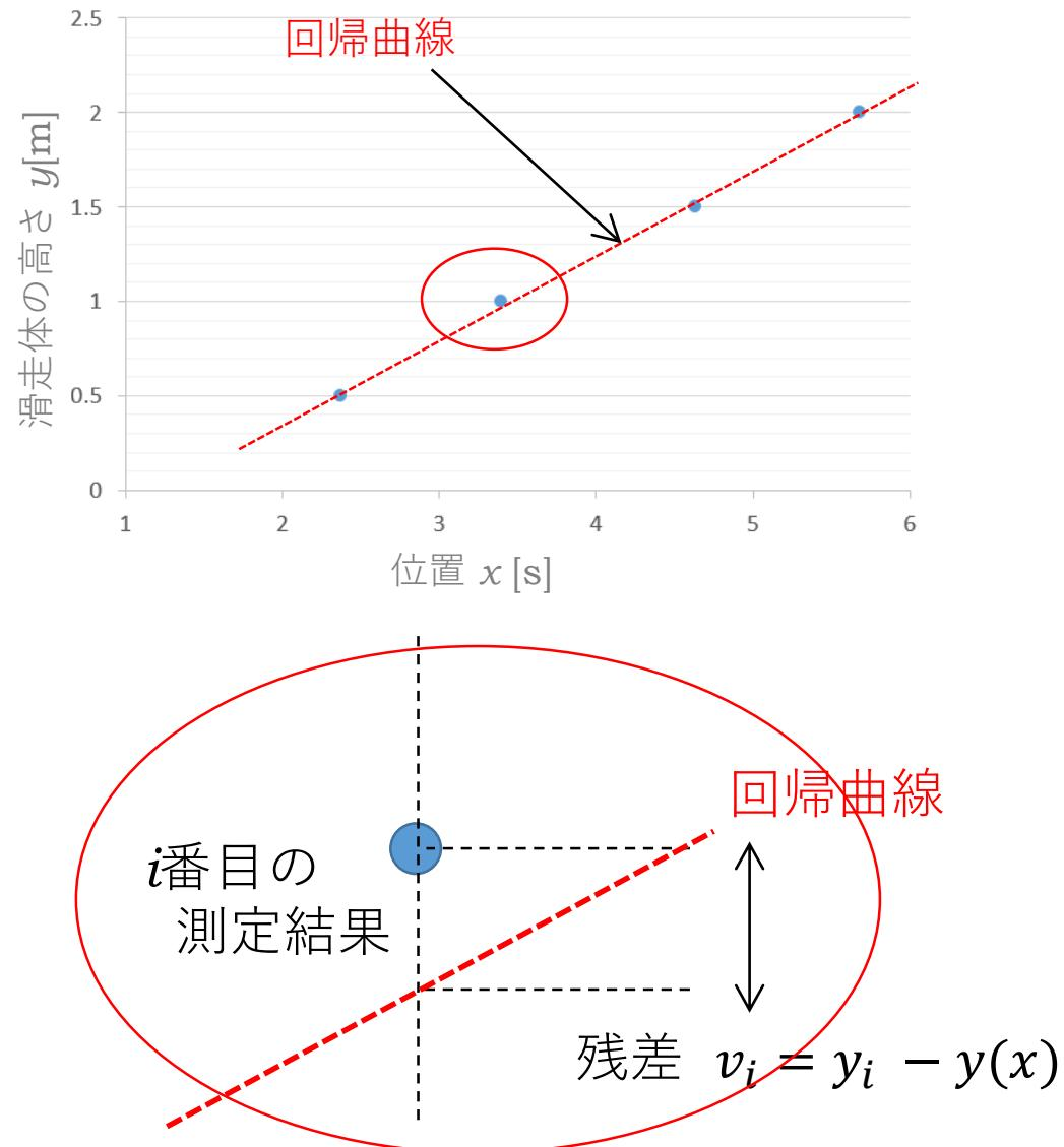
例えば、左図のような実験結果を考える。一般的に、グラフでは横軸が実験条件(ここでは物体の初期位置 $x$ )、縦軸が測定結果( $x$ という条件で測定された高さ $y$ )を示す。この結果から測定結果 $y$ を $x$ の関数で表すことを考える(回帰曲線を求める)。
