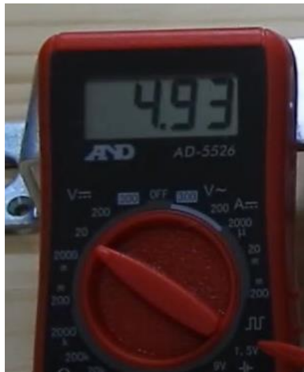
電圧測定 DCV 20V
