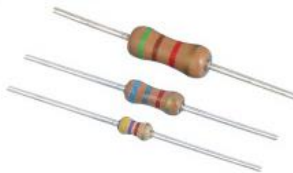
炭素被膜抵抗 絶縁材の周囲に炭素で膜をつけた
