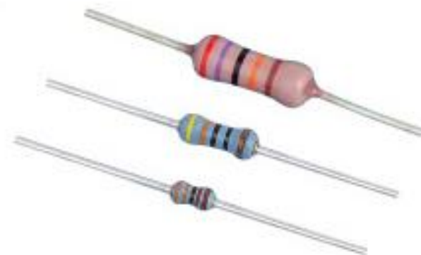
金属被膜抵抗 絶縁材の周囲に金属で膜をつけた抵抗で、 抵抗値の精度が高い
