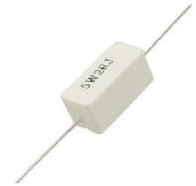
セメント抵抗 抵抗体をセメントで埋めた 数ワットの電力に耐える
